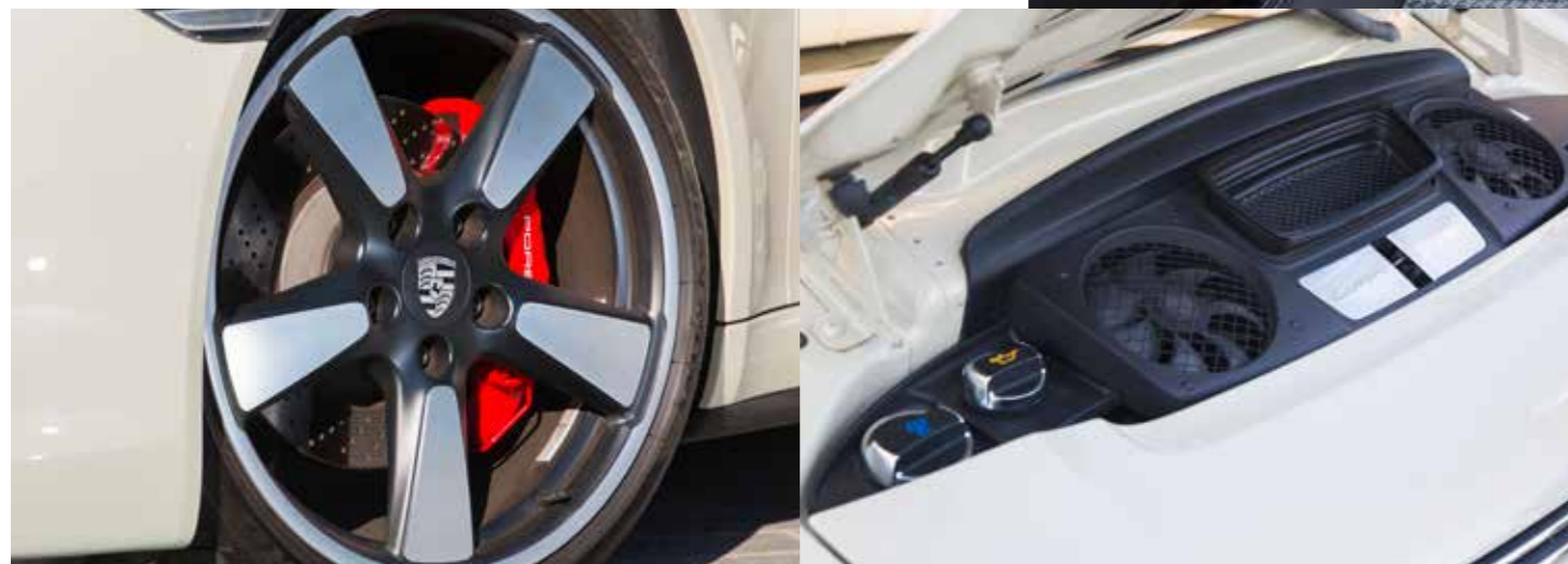
Depuis la génération 991, le moteur est intégralement encapsulé
